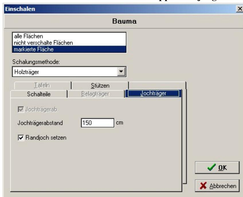
Dans l'onglet "Poutrelles d'ossature", il faut saisir la distance maximale autorisée entre les poutres d'ossature pour le plafond fini. Un calcul automatique de cette valeur n'est pas possible, car elle est fixée par le fabricant du plafond préfabriqué. Si vous oubliez de saisir cette valeur, vous en serez automatiquement averti lors du calcul.
