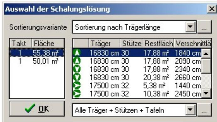
Dans la liste de gauche, toutes les surfaces de plafond sont listées avec la surface correspondante. En cliquant sur une entrée, la surface correspondante est sélectionnée. Il est également possible de cliquer directement sur la surface souhaitée dans le plan.
