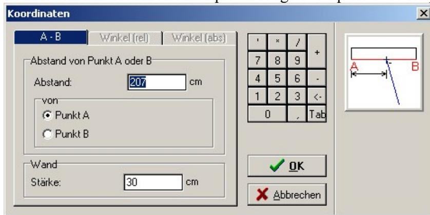
En outre, une boîte de dialogue s'ouvre dans laquelle vous pouvez indiquer la distance du nouveau mur mesurée à partir d'un de ces points "A" ou "B". Cette mesure se réfère toujours à la ligne dessinée en vert du mur. Si la 2e ligne se trouve du mauvais côté de la ligne verte, cela peut être modifié avec la commande "Changer le côté du mur".
